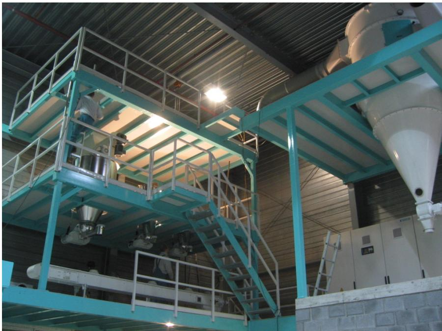
Die **Extruder-Anlage** und die dazugehörige Beschickung findet Platz auf vier Stockwerken, welche für Wartung und Unterhaltsarbeiten über Treppen erschlossen sind
